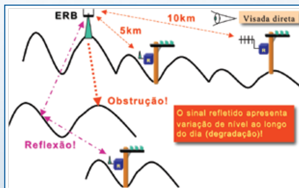
Figura 7: Exemplo de instrução quanto a escolha e instalação de antenas celulares.
